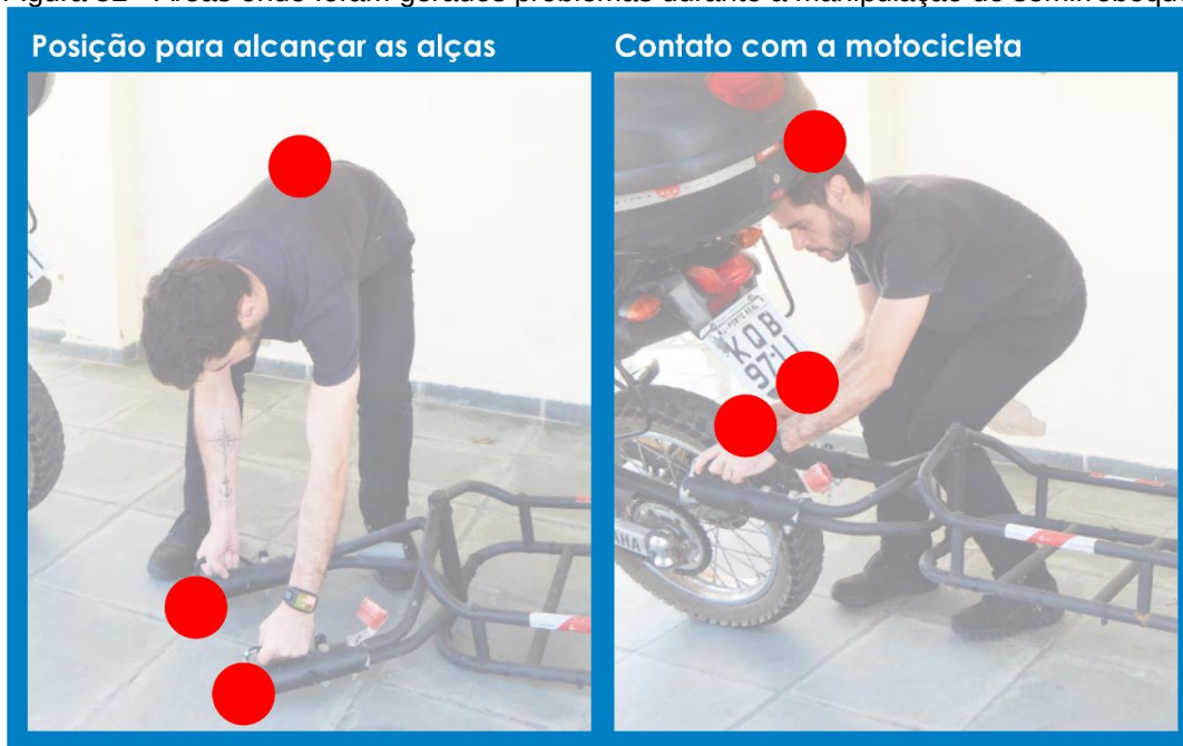
Figura 52 - Áreas onde foram gerados problemas durante a manipulação do semirreboque.
