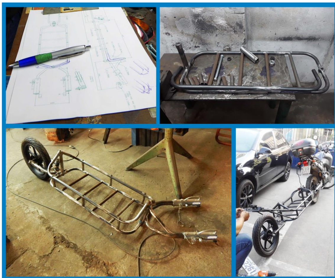
Figura 48 – Fabricação e emplacamento do protótipo.
