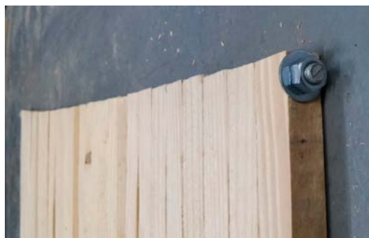
Figura 27. União para confecção do gabarito de curvatura.
