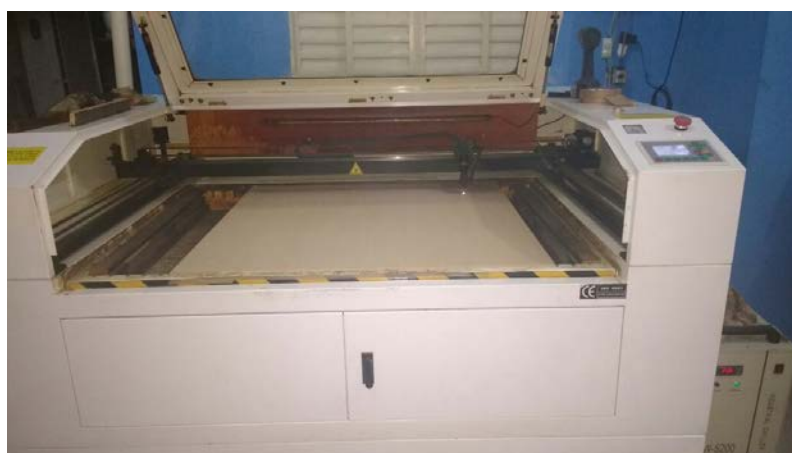
Figura 24. Máquina CNC de corte a laser para construção do perfil aerodinâmico do APP.
