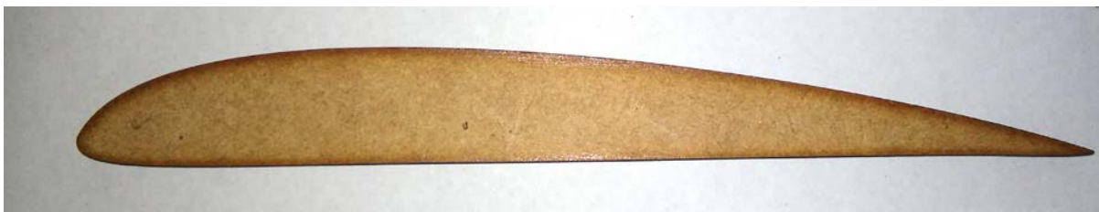
Figura 25. Perfil aerodinâmico do APP após impressão na máquina CNC.
