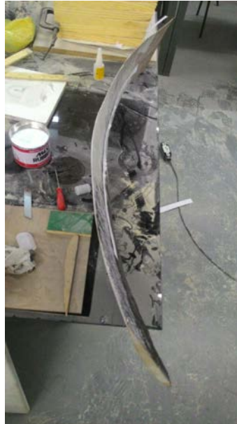
Figura 41. Molde em fibra de vidro.
