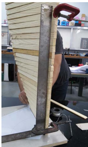
Figura 31. Preparação do ângulo de curvatura.
